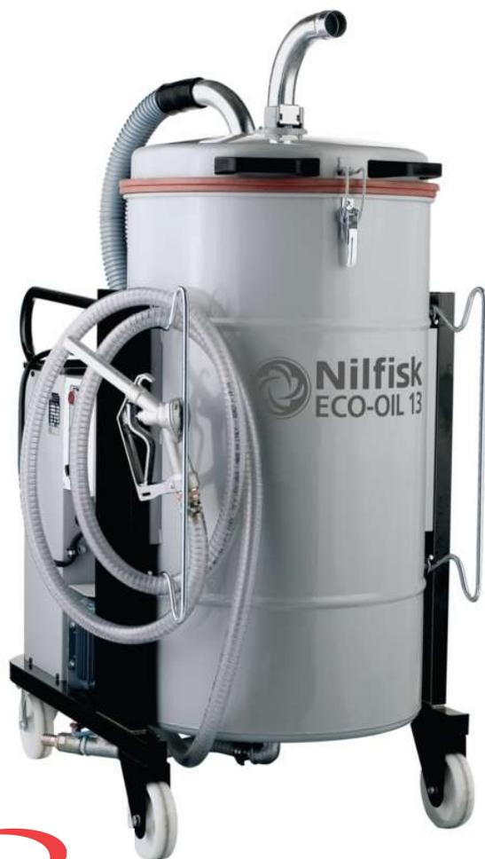
Le modèle ECO-OIL 13 (monophasé 1,3 kW) est spécifiquement conçu pour récupérer l'huile, les liquides visqueux et les copeaux. Il est également capable de séparer les liquides des solides à l'aide de la microfiltration et permettre ainsi à l'opérateur de recycler les huiles récupérées.
